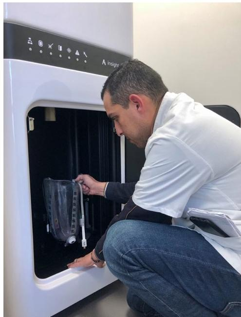
**d'Adapttech** : un dispositif d'évaluation d'emboîtures de prothèses dernier cri, équipé de capteurs de pression puissants, permettant d'obtenir des données quantifiées et, ainsi, d'améliorer le pronostic de marche des patients.
